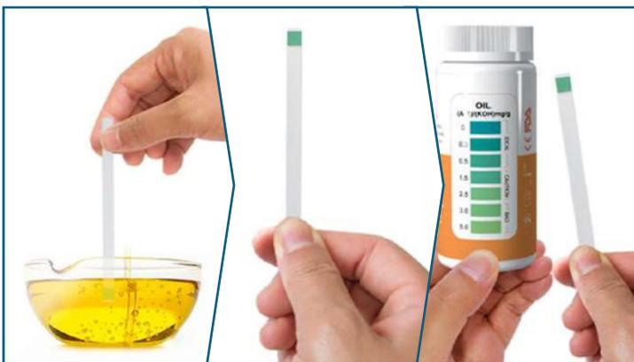
Il suffit de **tremper la bandelette** de test dans l'huile à tester **pendant 3 secondes**, attendre **2 minutes** et **comparer la couleur** de la bandelette avec l'échelle de couleur. L'étiquette du flacon vous montre la valeur seuil pour vous aider à prendre une décision **rapide, simple et efficace**.
